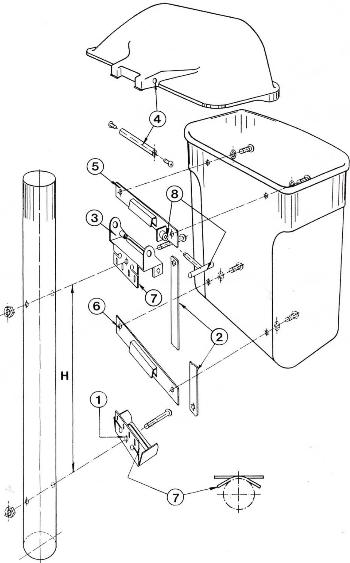
Fäste ① + ③ kan monteras på stolpe eller vägg. Montering kan ske genom bandning, med skruv eller genom svetsning. Vid montering på stolpe formas fäste ① och ③ efter stolpens profil se ⑦.
