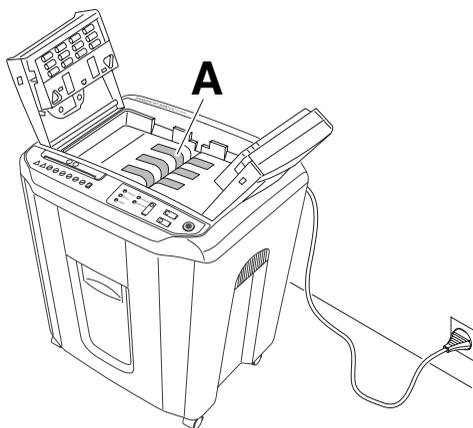
**DE** Bei nachlassender Schneidleistung oder nach jedem gefüllten Auffangbehälter Schneidwerk ölen! (siehe Bild)
