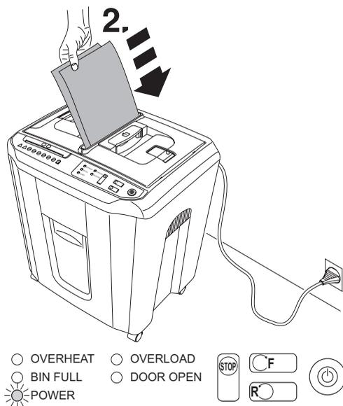
**RU** Уничтожение в ручном режиме. Машина автоматически останавливается, если уничтожается слишком большое количество листов одновременно. При замятии бумаги автоматически включается реверс. (загорается красный светодиод-перегрузка), аварийный звуковой сигнал звучит 3 раза. Удалите бумагу (1.). Установите меньше бумаги. (2.). Максимальное количество листов бумаги: 5 листов (80 гр/м2), формат А4.
